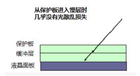
由于保护板和缓冲层具有不同的折射率, 从保护板进入缓冲层时,
