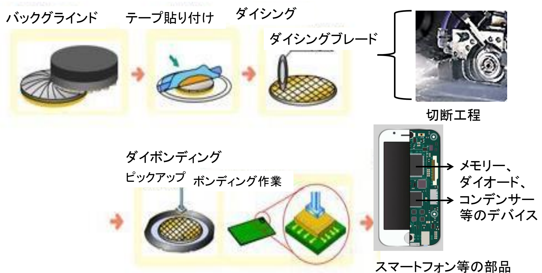
Fig1. デバイスの製造工程のイメージ図
