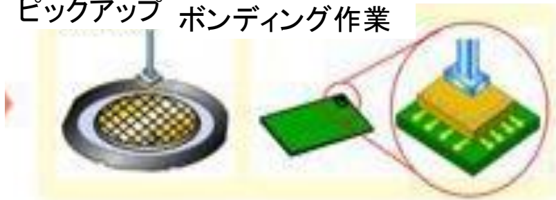
Fig5. ダイボンディングのイメージ図
