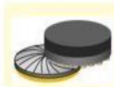
Fig2. バックグラインドの図
