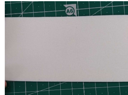
④真空断熱材 (500 \mu m)
